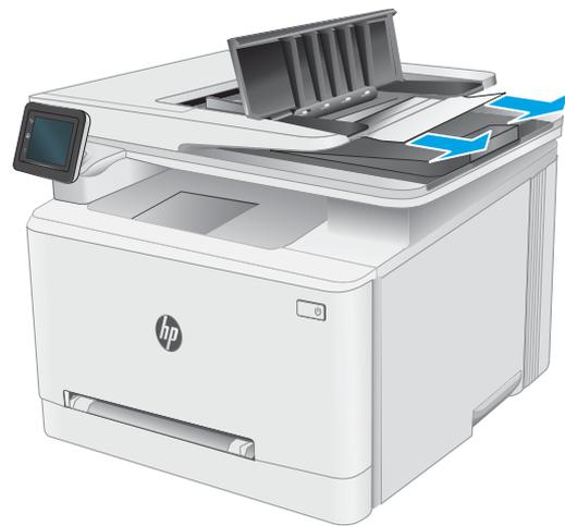
5. Ouvrez le couvercle du scanner. Si le papier est bloqué derrière le renfort en plastique blanc, retirez-le doucement.
